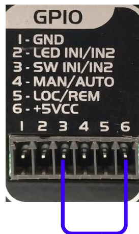
Figura 11 - tensão aplicada no pino 3, IN B comutada para saída
