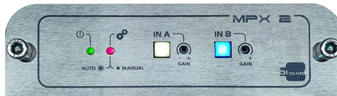
Figura 7 - painel frontal com os dois botões pressionados
