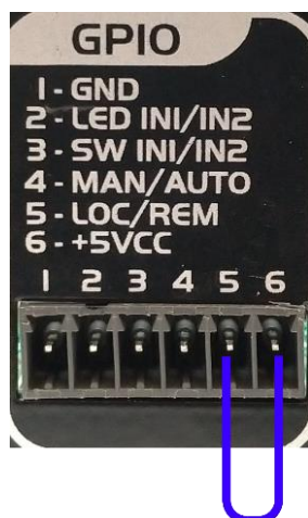
Figura 13 - tensão aplicada no pino 5, modo remoto ativado
