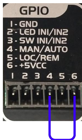
Figura 12 - tensão aplicada no pino 4, modo automático ativado
